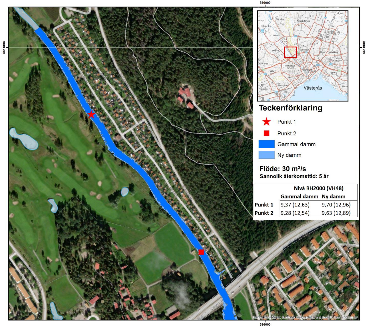
Figur 10. Vattnets utbredning för ett flöde på 30 m 3 /s.
