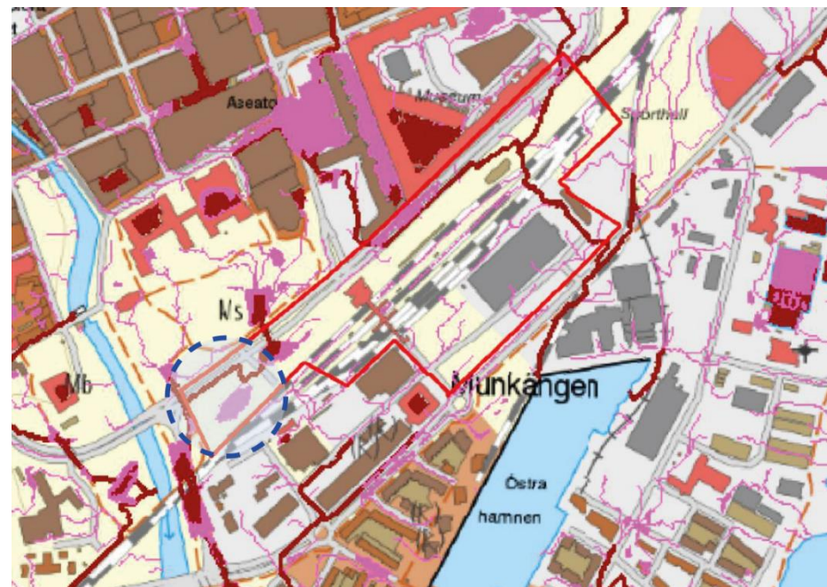
Figur 30 Utdrag ur SMHI:s skyfallskartering för centrala Västerås. Planområdet markerat i blå streckad linje. Röda områden i figuren visar potentiella riskområden för en vattennivå på över 1 m om ett skyfall skulle inträffa. Rosa områden visar potentiell risk för vattennivå över 0,2 m. Röda och rosa linjer visar potentiella större respektive mindre flödeslinjer vid händelse av skyfall. Bildkälla: Länsstyrelsens WebbGIS.
