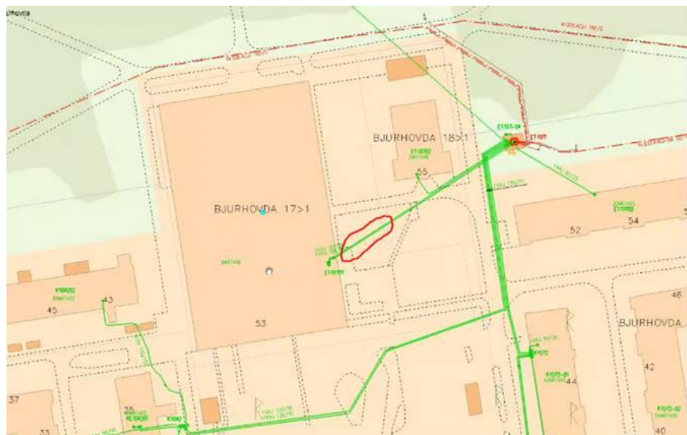
Figur 7 Elnätsledningar som tidigare försörjde tidigare fastighet.
