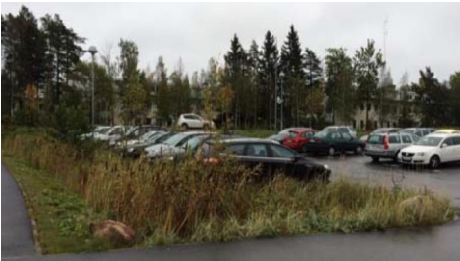
Figur 2. Exempel på vegeterat svackdike. Foto: Sweco.
