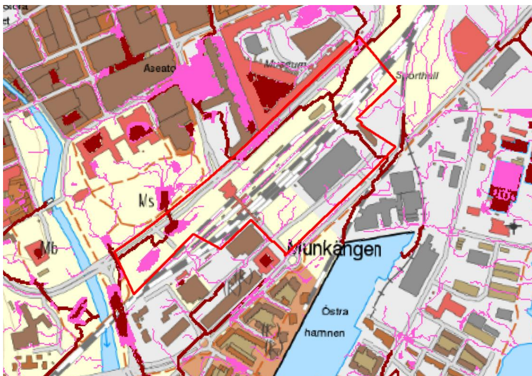
Figur 9. Utdrag ur SMHI:s skyfallskartering för centrala Västerås. Planområdet markerat i röd linje. Röda områden i figuren visar potentiella riskområden för en vattennivå på över 1 m om ett skyfall skulle inträffa. Rosa områden visar potentiell risk för vattennivå över 0,2 m. Röda och rosa linjer visar potentiella större respektive mindre flödeslinjer vid händelse av skyfall. Bildkälla: Länsstyrelsens WebbGIS.
