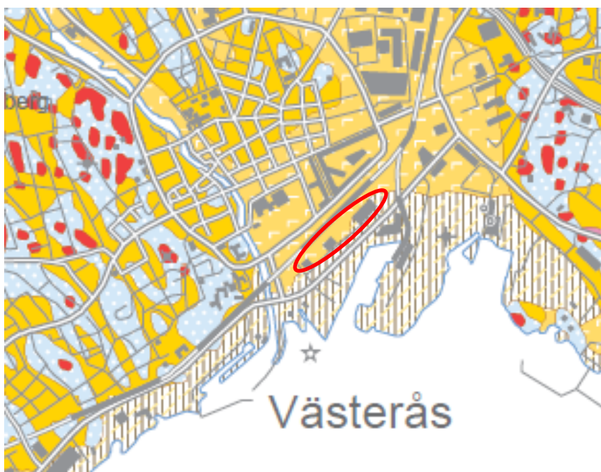
Figur 7. Utdrag från SGU:s Jordartskarta som visar att marken inom och runt planområdet till övervägande del består av postglacial finlera, förutom längst söderut i planområdet där marken består av fyllning som underlagras av lera-silt. Bildkälla: sgu.se
