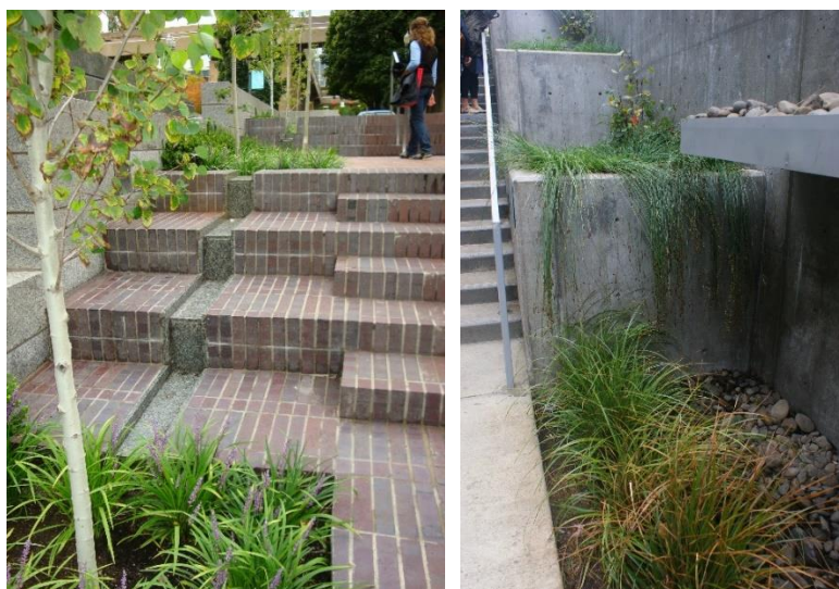
Figur 20. Olika alternativ att leda vatten inom ett område med nivåskillnad.
