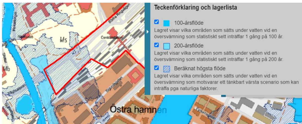
Figur 12. Karteringen från MSBs översvämningsportal visar att beräknat högsta flöde från Svartån översvämmar en del av planområdet (MSB, 2021). Röd linje visar plangrän.
