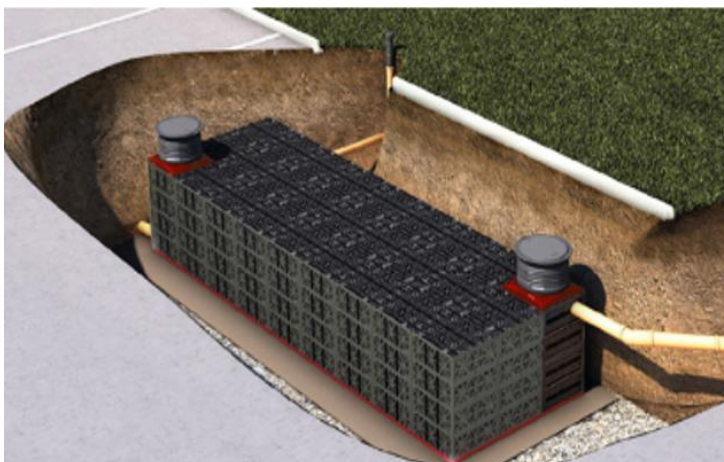
Figur 17. Illustration av ett magasin med dagvattenkassetter.
