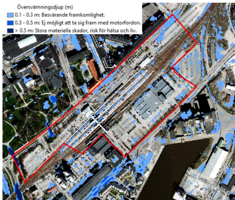
Figur 11. Beräknat översvämningsdjup vid ett 100-årsregn. I analysen är dagvattenledningarnas kapacitet medräknade. Plangräns markerat i rött. (Mälarenergi)
