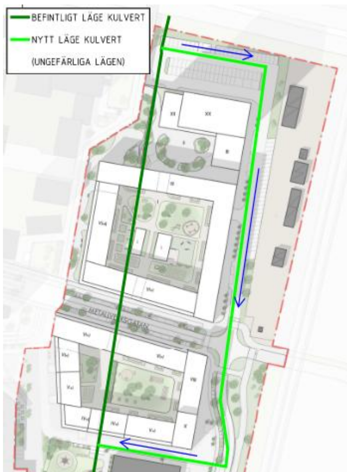
Figur 5-2. Omläggning av Emausbäcken i två 1200 PE-ledningar med anslutning till befintlig kulvert i norra delen och södra delen av utredningsområdet (Förhandskopia Mälarenergi 2022-08-18).
