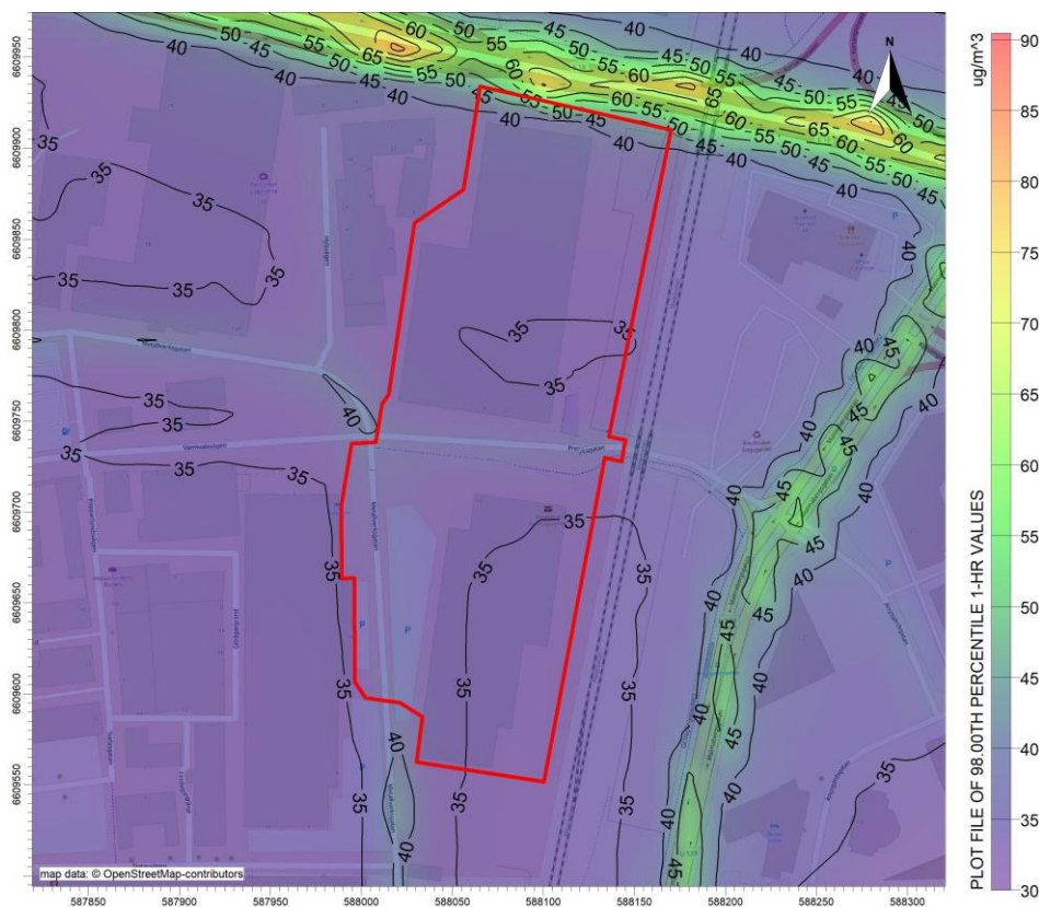
Figur 8. Nuvarande situation , beräknade halter av kvävedioxid som timmedelvärdet (98-percentil). Planområdet markeras med röd linje.
