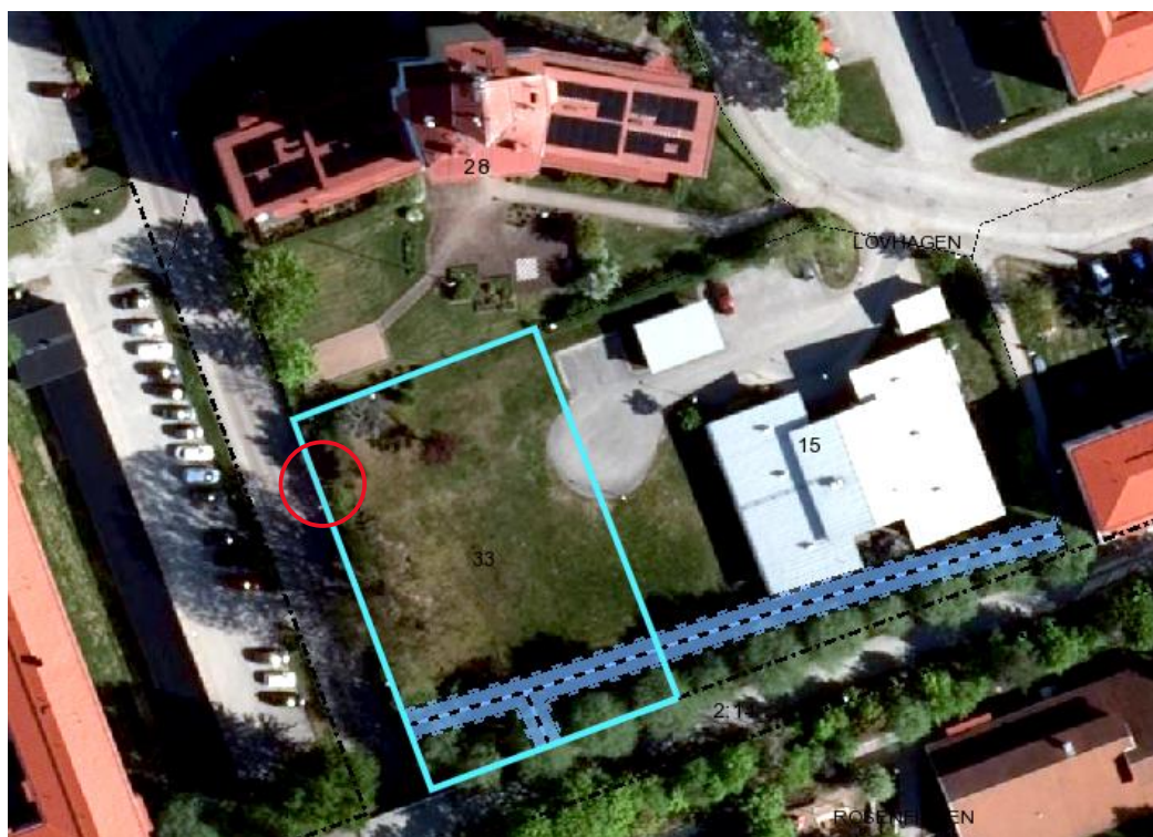
Bild ovan visar tidigare vändplan. Idag har den byggts om till en T-vändning. Placeringen av fjärrvärmeledningen är markerad med blått och får inte bebyggas. Röd cirkel visar föreslagen placering av ny in/utfart.
