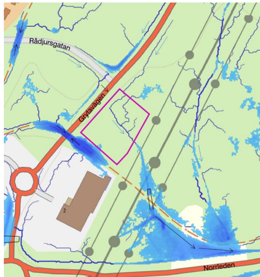
10 Lågpunkter och rinnvägar vid 100-årsregn med 60 minuters varaktighet. Källa: Lektus
