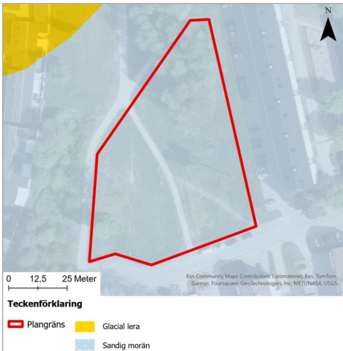
Figur 4. Jordartskarta från Sveriges Geologiska Undersökning (SGU, 2024). Kartan är hämtad från SGU:s kartvisare för jordarter 1:25 000 – 1:100 000. Ungefärlig plangräns visas med röd linje.
