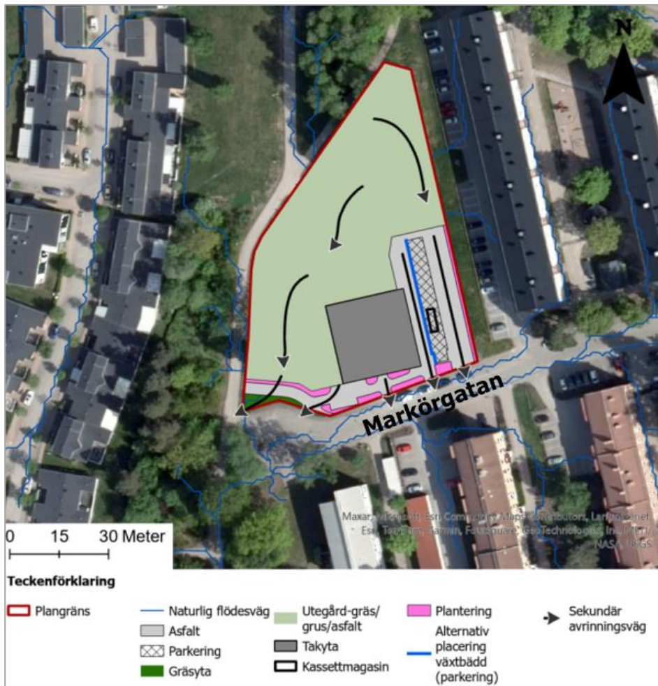
Figur 18. Figuren visar rekommenderade sekundära avrinningsvägar vid skyfall, dvs. lågstråk och lutningar i terrängen där stora volymer vatten kan avrinna. Ortofoto: © Lantmäteriet
